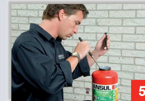
Controleren van de coating blustoestel door visuele inspectie
