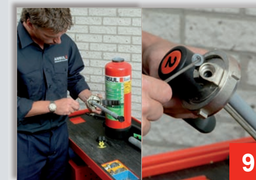
Vervangen van O-ring en afdichtingen
