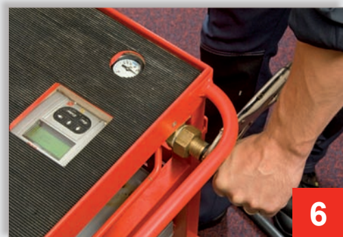
6 Meten minimale waterdruk (1,3 bar) en opbrengst (21 ltr/min) bij 3/4" slang
